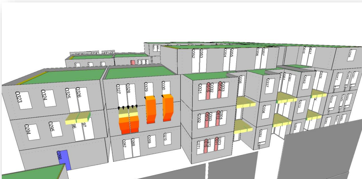
Figuur 4: Aanzicht van brandcompartiment 19 brandend, vanuit de noordgevel gezien.
