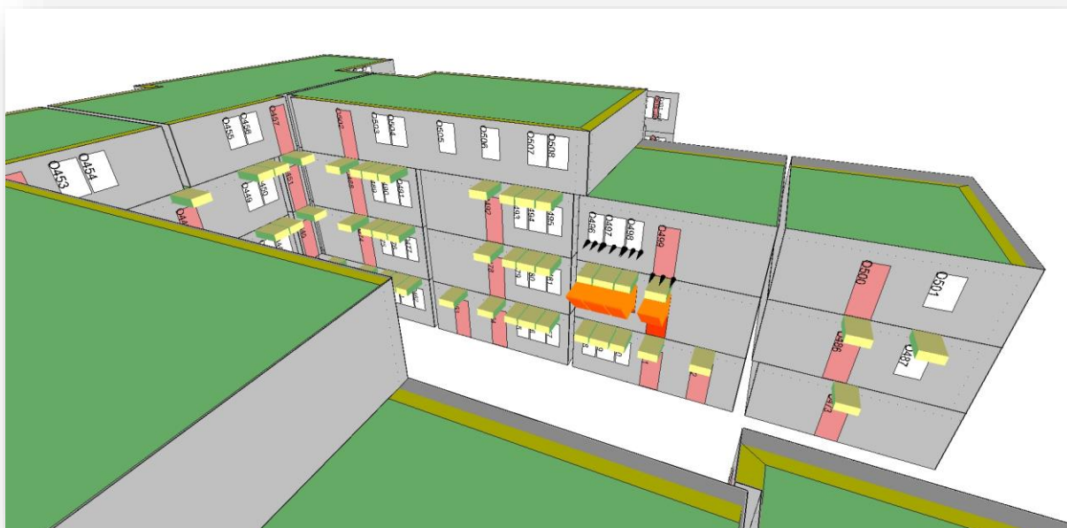
Figuur 7: Aanzicht van brandcompartiment 19 brandend, vanuit de binnen gevel gezien.
