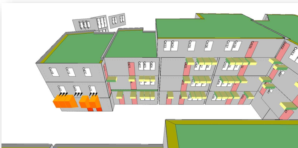
Figuur 5: Aanzicht van brandcompartiment 1 brandend, vanuit de binnen gevel gezien.
