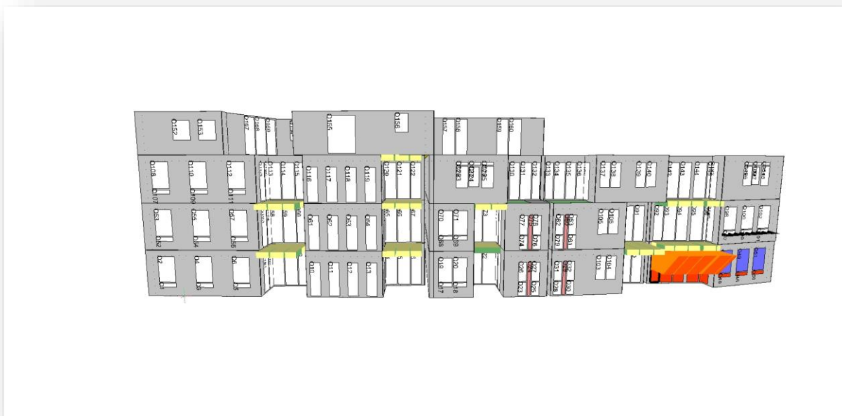
Figuur 2: Aanzicht van brandcompartiment 1 brandend, vanuit de zuidgevel gezien.
