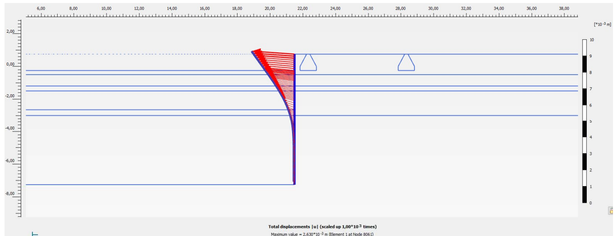
verplaatsing damwand stage 4 - ontgraving stempelraam
