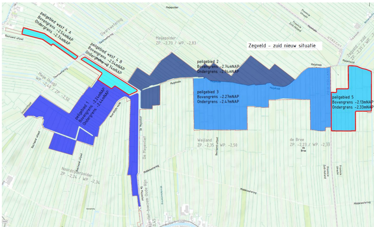
Figuur 45 Ligging van de peilgebieden en peilscheidingen. De bovengrens en ondergrens van de nieuwe streefpeilen zijn voor ieder gebied aangegeven. De twee nieuwe peilgebieden ten opzichte van het VO zijn met rood omkaderd. De peilscheidingen liggen rondom de peilgebieden.
