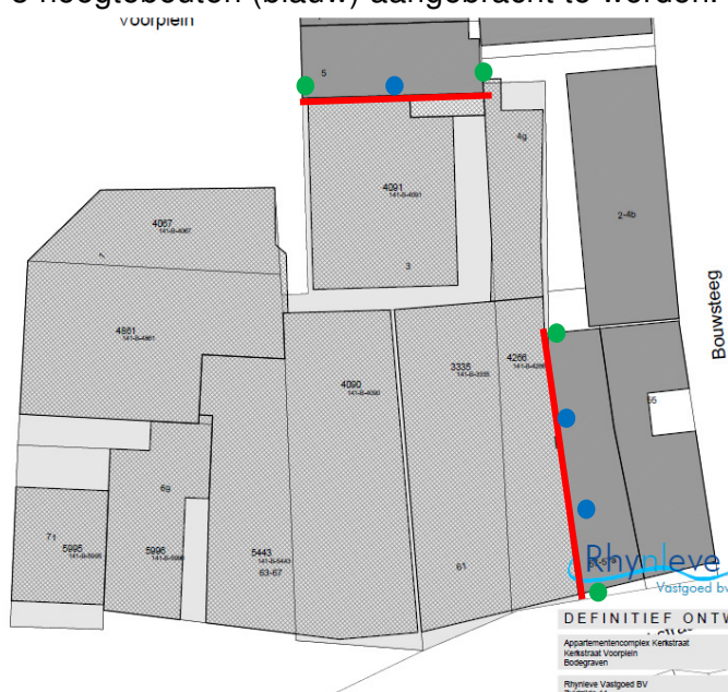
figuur 18 – overzicht te verwijderen delen
