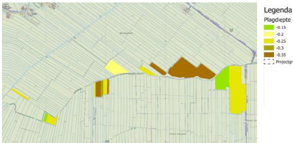
Figuur 32 Plaglocaties en -dieptes voor vochtig hooiland en nat schraalland uit het VO.
